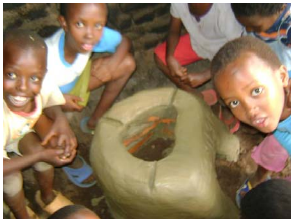
Foyer Amélioré juste après la construction
